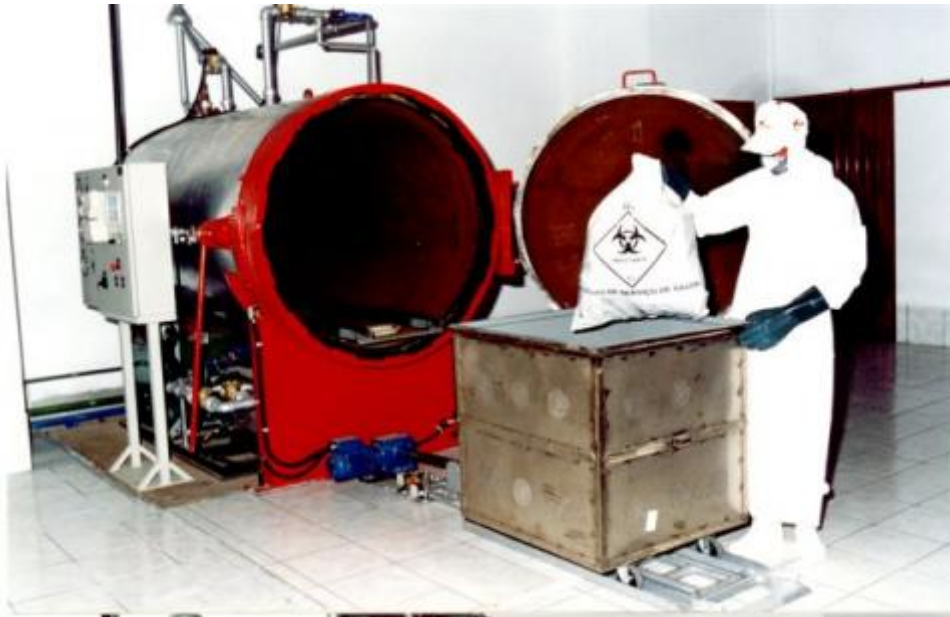
Figura 10.12 - Autoclave empresa TUCANO Obras e Serviços Ltda
